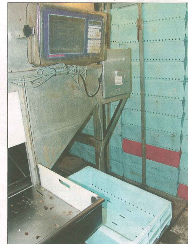
Den elektroniske vægt er i brug, når kasserne fyldes efter sortering af fisken. (Foto: Karsten Bräuner)
