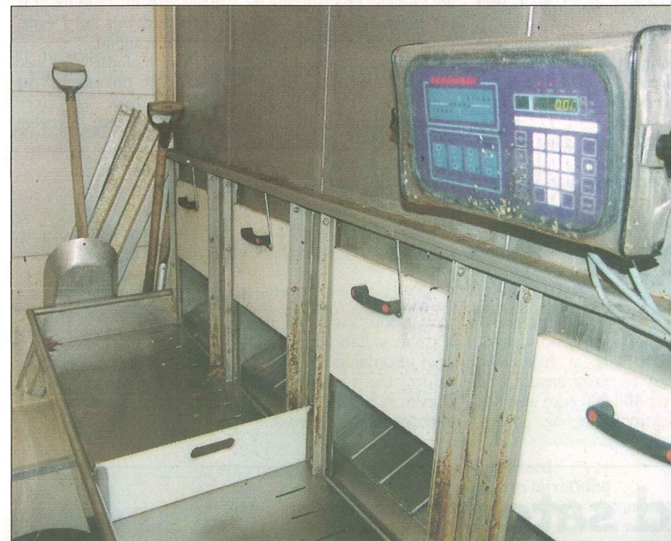
Sorterebordet i lasten bruges til de store fisk og er blandt andet udstyret med vægt. (Foto: Karsten Bräuner)
